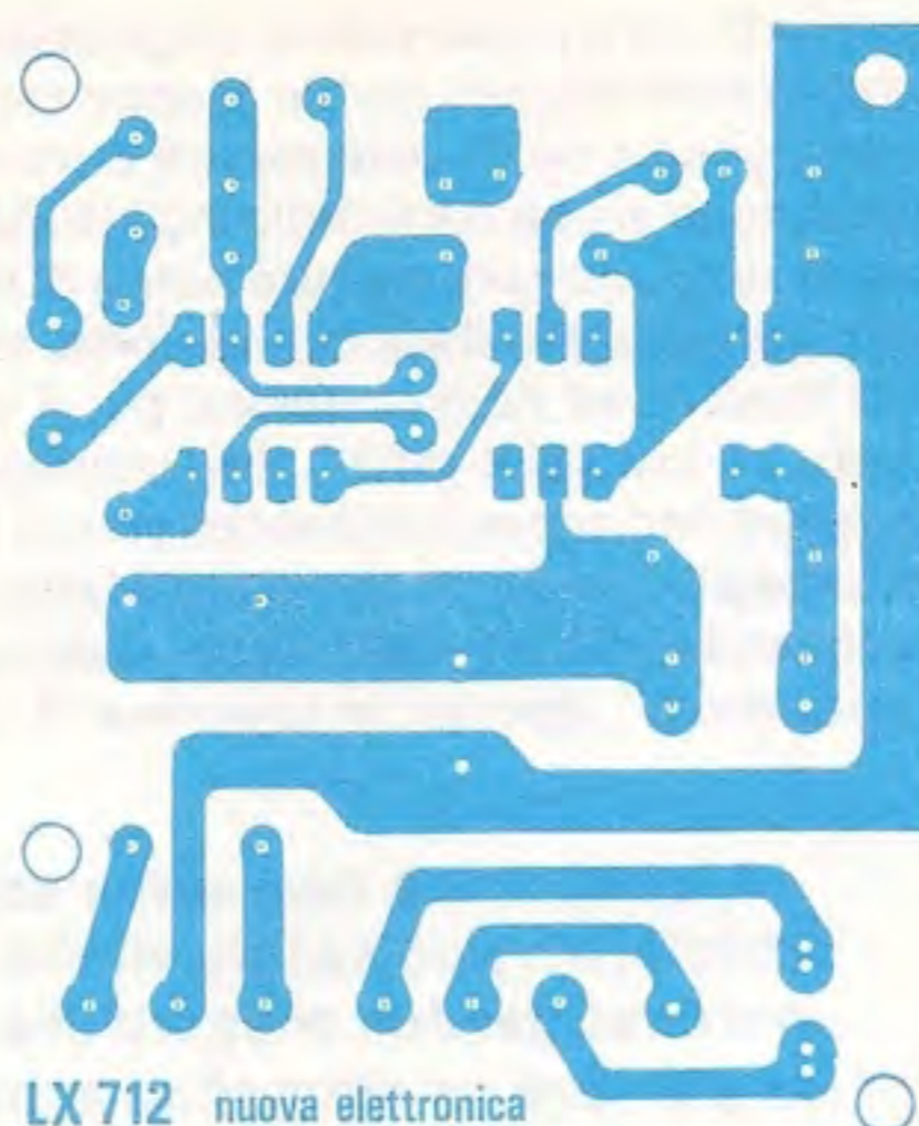
Fig. 5 Disegno a grandezza naturale del circuito stampato che forniamo forato e serigrafato.
