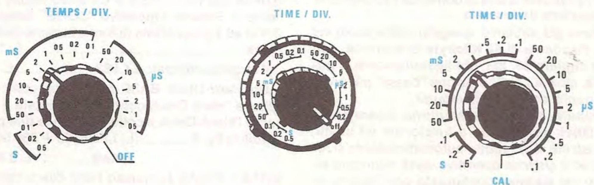
Fig. 1 In ogni oscilloscopio la manopola del TIME/BASE dispone di una propria suddivisione dei tempi, in Secondi - milliSecondi - microSecondi come qui sopra riportato. Come spiegato nell'articolo, conoscendo il "tempo" e controllando quanti quadretti occupa in orizzontale una sola sinusoide, potrete rilevare con una buona approssimazione l'esatta FREQUENZA.
